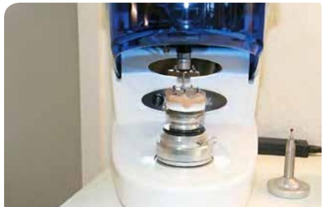
Abb. 6: Der Tisch des taktilen Renishaw-Scanners wurde in 0°-Position fixiert.
