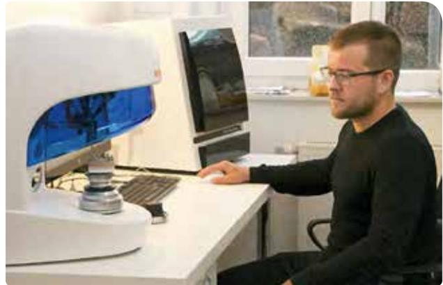
Abb. 1: Der taktil arbeitende DS10 von Renishaw und der Streifenlicht-Scanner Tizian Smart-Scan von Schütz Dental.
