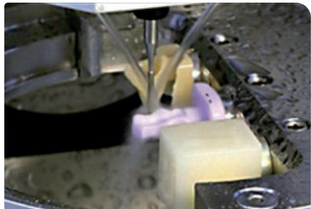
Mit der Flüssigkeitskühlung schleifen Sie auch Blöcke aus Vollkeramik.
