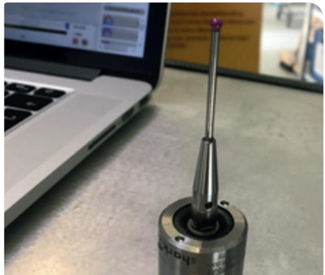
Taktiler Messtaster zum Kalibrieren der Maschine und zum Einmessen von Preface und Glaskeramik Rohlingen sowie Qualitätskontrolle von Außenteleskopen direkt nach der Fertigung oder Ermittlung von evtl. notwendigen Nachfräsungen.
